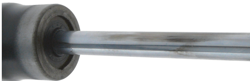
Ilustracja 2: Jednostronnie zużyta powłoka chromowa tłoczyska z powodu niewłaściwego montażu (montaż z naprężeniem)
