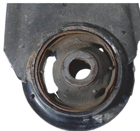
Ilustracja 3 Uszkodzone łożysko gumowo-metalowe
