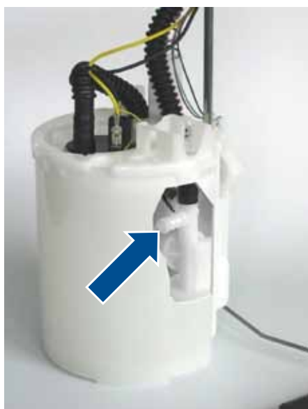
Rys. 1: Widok do wnętrza modułu doprowadzania paliwa (szkic) ze ślepym króćcem
