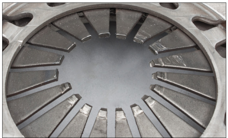
Foto1: Uszkodzona przez brak wstępnego napięcia sprężyna talerzowa
