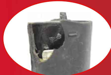
Uszkodzona lub pęknięta wtyczka lub wtyki. Przecięte przewody
