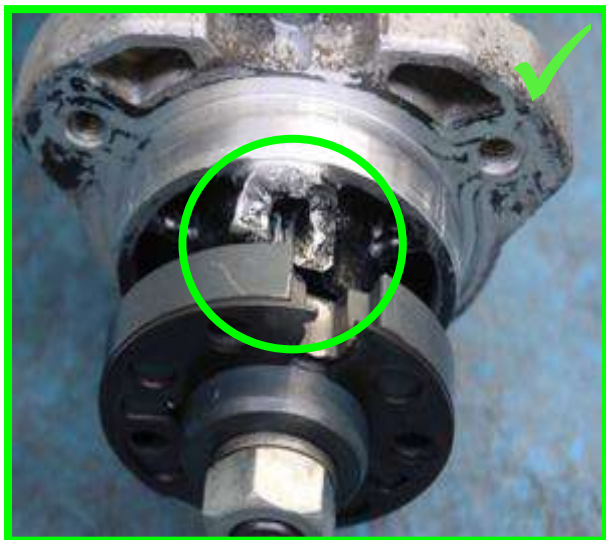
Uszkodzenia obudowy → dopuszczalne
