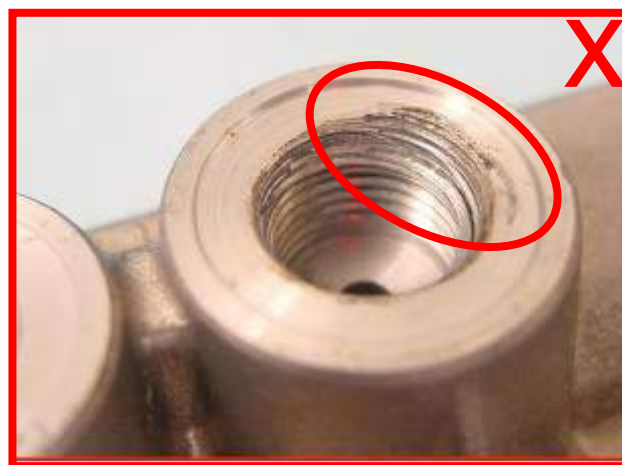
Uszkodzenia gwintów → niedopuszczalne
