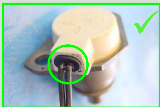
Uszkodzenie izolacji → zwrot akceptowalny
