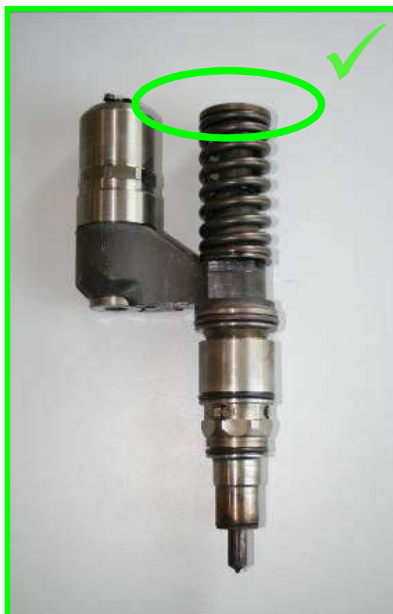
Brak trzpienia przy talerzyku sprężyny → dopuszczalne
