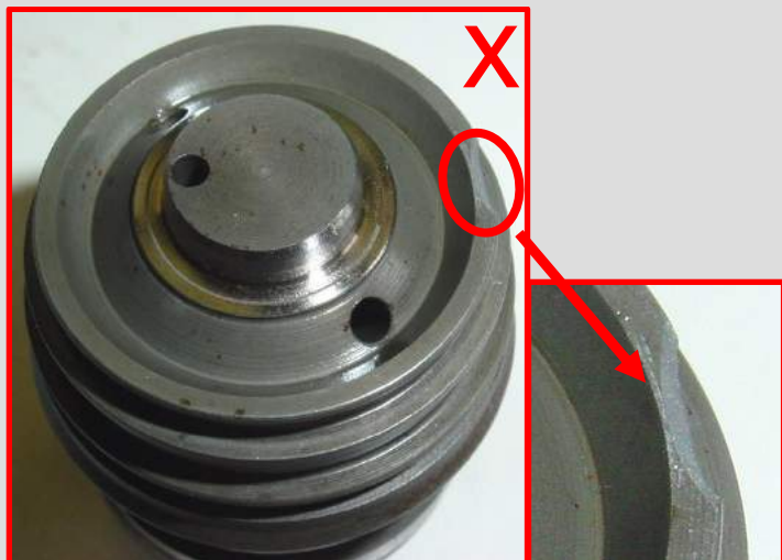
Zniekształcenia korpusu zaworu → zwrot nie akceptowalny
