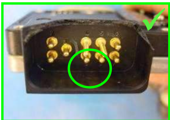
Uszkodzone piny → dopuszczalne
