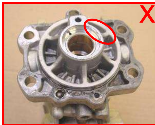
Uszkodzenia w wewnętrznych częściach → niedopuszczalne
