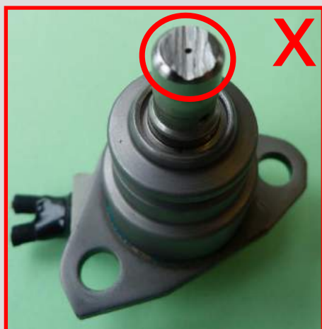
Ciężkie uszkodzenia, ukruszenie, nadłamania na zaworze → zwrot nie akceptowalny
