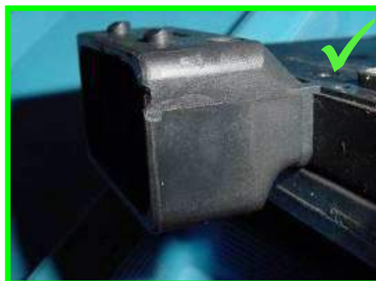
Nieznacznie uszkodzona wtyczka max 2mm → dopuszczalne
