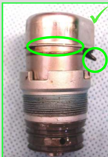
Podważony kołpak ochronny i odcięty kabel. → zwrot akceptowalny
