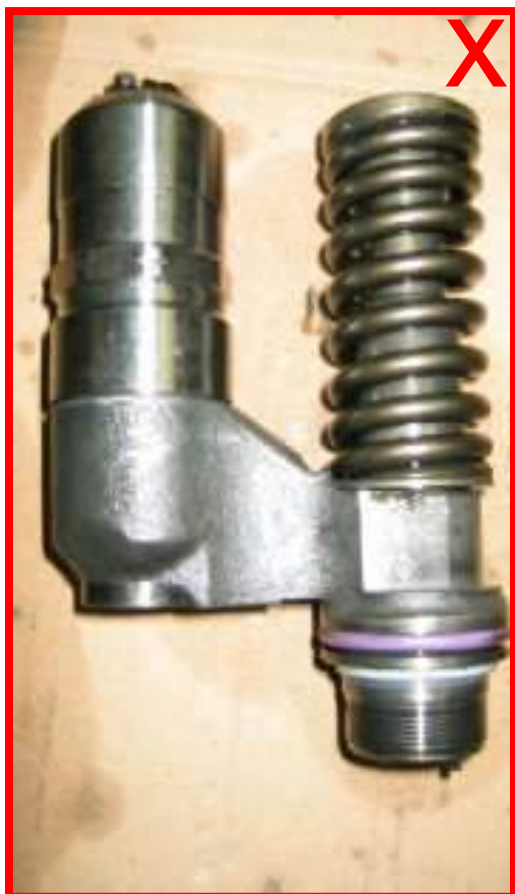
Brak rozpylacza → niedopuszczalne
