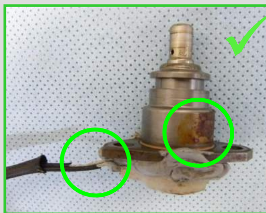
Uszkodzenie izolacji → akceptowalne Korozyja na kołnierzu → akceptowalne
