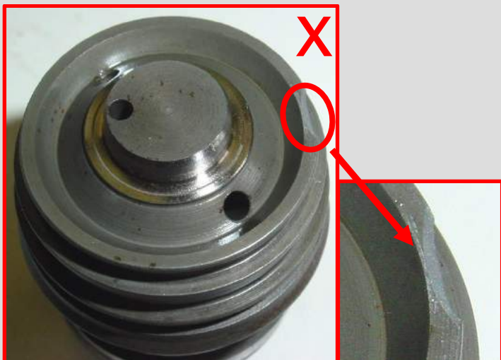
Zniekształcenia korpusu zaworu → zwrot nie akceptowalny
