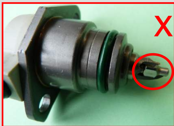
Ciężkie uszkodzenia, ukruszenie, nadłamania na zaworze → zwrot nie akceptowalny
