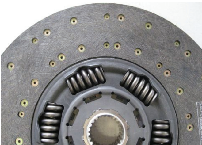
Rys. 3: Okładzina od strony skrzyni biegów
